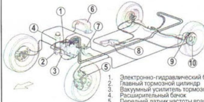
1. Электронно-гидравлический блок управления
