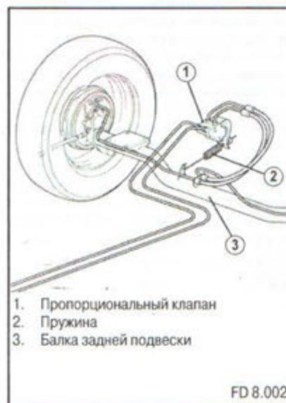
В тормозной системе без **ABS** предусмотрен пропорциональный клапан, регулирующий тормозное усилие задних
