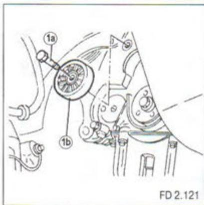
Открутите винты (1a) крепления многофункционального кронштейна натяжных механизмов (1b).
