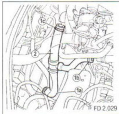
Аналогично нижнему шлангу извлеките верхний шланг радиатора из моторного отсека, предварительно отсоединив его от радиатора (**1a**) и от корпуса термостата (**1b**).
