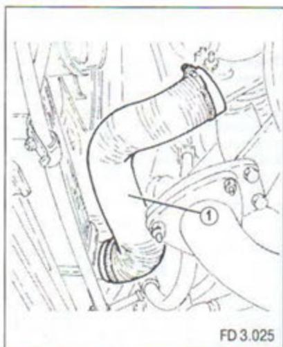
Открутите винт (1a) и отсоедините от компрессора трубку (1b), соединяющую его с конденсором.
