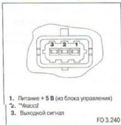
Данные, поступающие от датчика, используются для регулирования давления впрыска и для регулирования продолжительности открытия форсунок.
