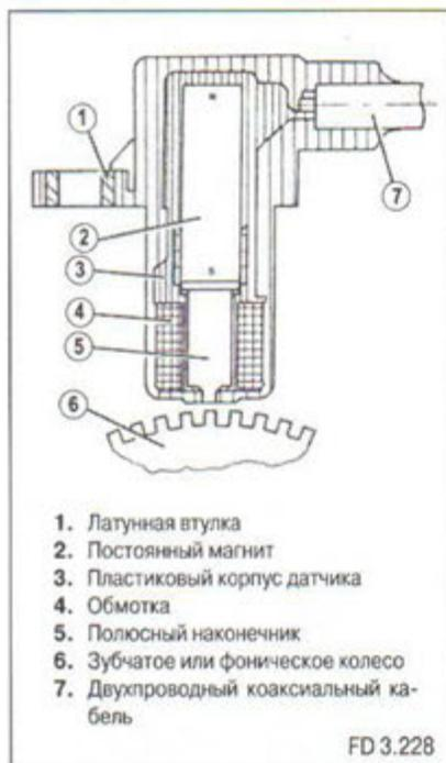
При прохождении зуба фониического колеса напротив полосного наконечника датчика за счет изменения зазора между наконечником и зубом в обмотке датчика индуктируется положительный импульс тока. При прохождении места с увеличенным зазором индуктируется противоположный по знаку импульс.
