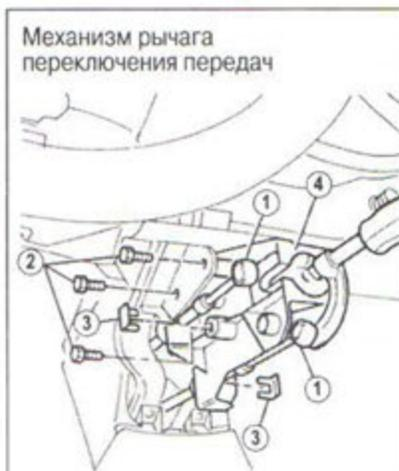
**Механизм рычага переключения передач**
