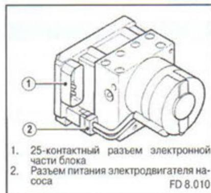
25- контактный разъем электронной части блока
