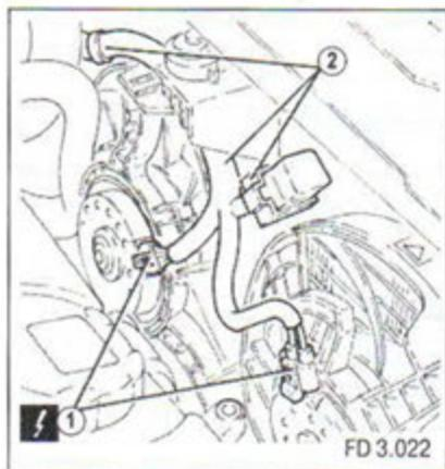
Открутите гайку (1a) и снимите верхнее центральное крепление (1b) радиатора.
