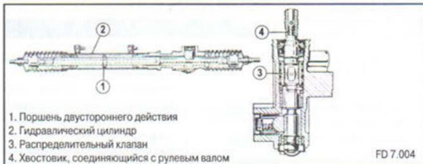
Распределительный клапан, по сути, является механической следящей системой, которая, реагируя на вращение рулевого вала, подает рабочую жидкость под давлением в соответствующую полость гидроцилиндра.
