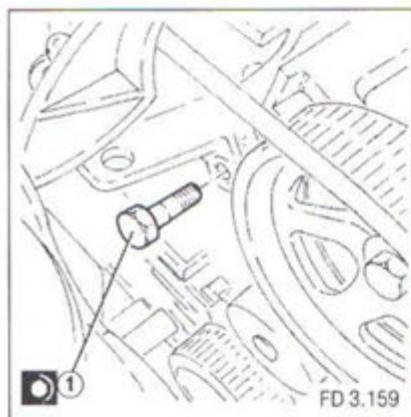
Установите крышку (1а) клапанного механизма и затяните винты (1b) крепления моментом 9-11 Нм (резьба М6).
