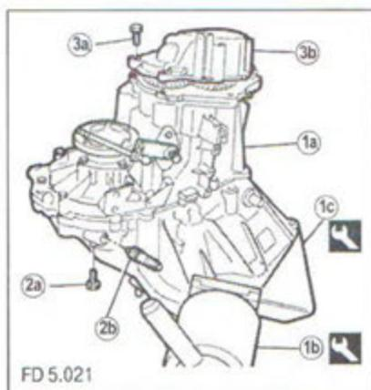
Открутите винты (1а) и снимите кронштейн (1б) крепления тросов управления МКПП.
